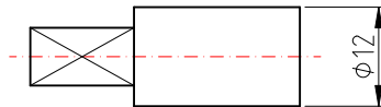
Illustration 13-15: Les cotations de diamètre comportent souvent un symbole de diamètre, en particulier lorsque la forme circulaire de l'élément n'est pas compréhensible d'emblée.
