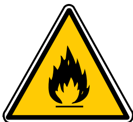
Matières inflammables ou haute température (1)
