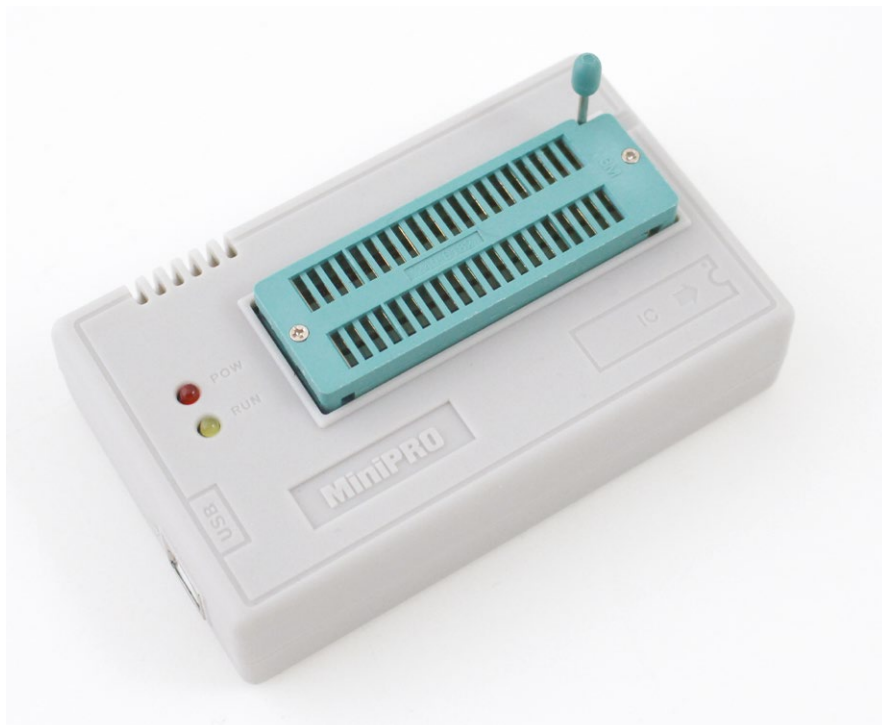
Le Minipro TL866CS est de construction solide et se présente sous la forme d'un « pavé » de 65x100x25 millimètres. Il se connecte à un PC, un Mac ou une Raspberry Pi à l'aide d'un simple câble USB.
