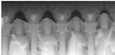
Figure 2.27. a) Image maîtresse et b) carte de profondeur (galerie des Rois, cathédrale d'Amiens)
