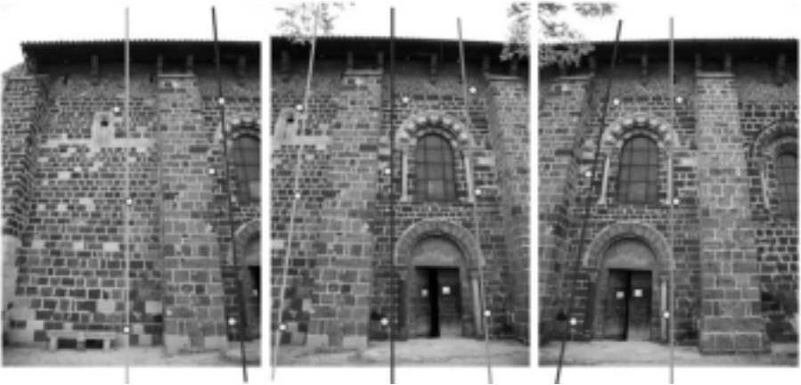
Figure 2.21. Nadirs et points de liaison
