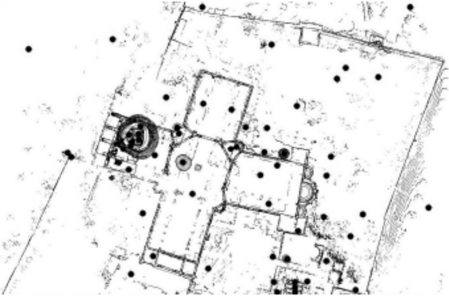
Figure 3.8. Vue en plan d'une partie du chantier de lasergrammétrie de Saint Syméon (Syrie) : au total, le site s'étend sur plus de 5 km 2 et comporte 297 stations laser (points noirs sur la figure)
