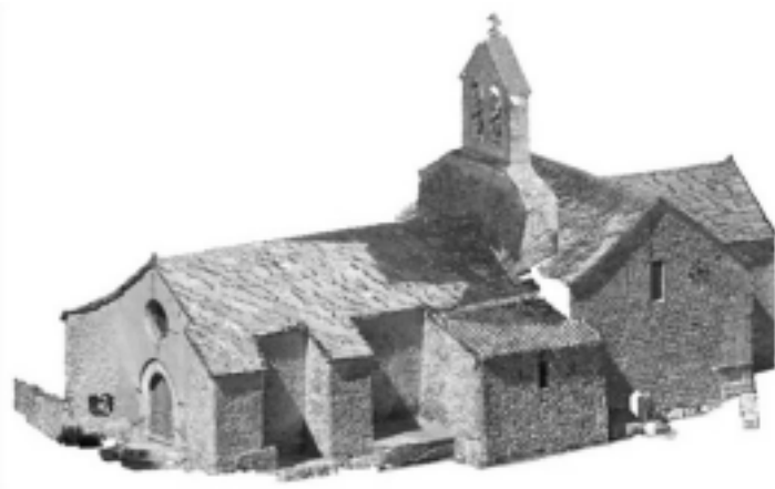
Figure 2.24. Nuage de points 3D en couleurs, imprimé ici en noir et blanc (chapelle de Lincel)
