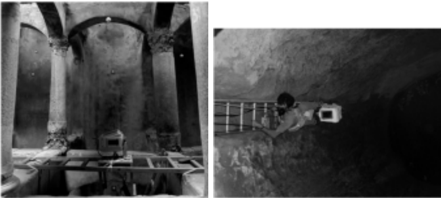
Figure 3.6. Exemples d'adaptation au site d'étude : numérisation dans une citerne (Borel et al., 2010) et dans un puits
