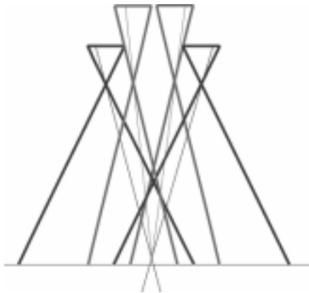
Figure 2.17. Plus la focale est longue, plus l'intersection des rayons perspectifs homologues est ambiguë
